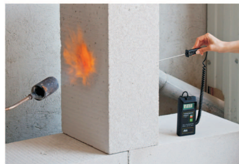
Foto 10 – Distribuția temperaturii pe fața neexpusă la foc a epruvetei în minutul 240 al încercării la focul standard
