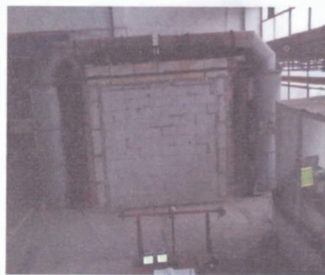
Foto 10 – Distribuția temperaturii pe fața neexpusă la foc a epruvetei în minutul 240 al încercării la focul standard
